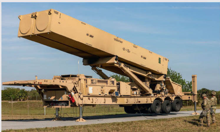
Буксируемая пусковая установка TEL опытного прототипа ракетного комплекса средней дальности «Dark Eagle».
