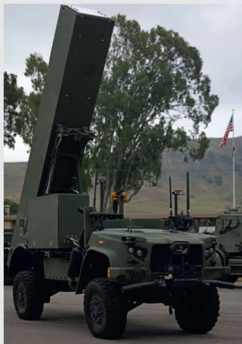
Безэкипажная мобильная ПУ ракетного комплекса LRF, оснащенная ТПК со стратегической крылатой ракетой TLAM, либо её противокорабельной версией MST на базе СКР «Tomahawk Block V».
