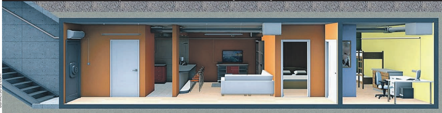
Вот такой четырехкомнатный бункер на глубине 2 - 3 метров дает возможность пережить не прямое попадание бомбы в коттедж, поскольку находится в стороне от него и имеет, как правило, два выхода и автономную систему жизнеобеспечения.
