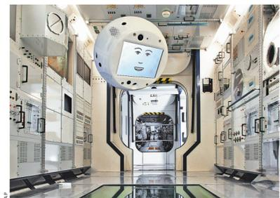
У «летающего мозга» есть моторы и пропеллеры для передвижения по станции и тысяча фраз в базе — для общения с экипажем.
