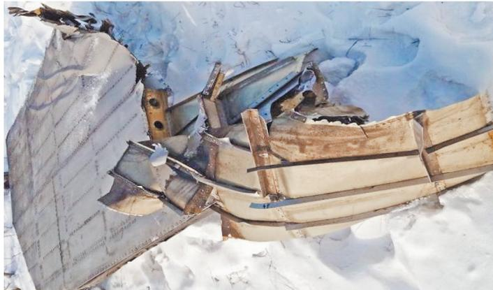
Во время взлета лайнера, по версии следствия, левую створку грузового отсека оторвало порывом воздуха.
