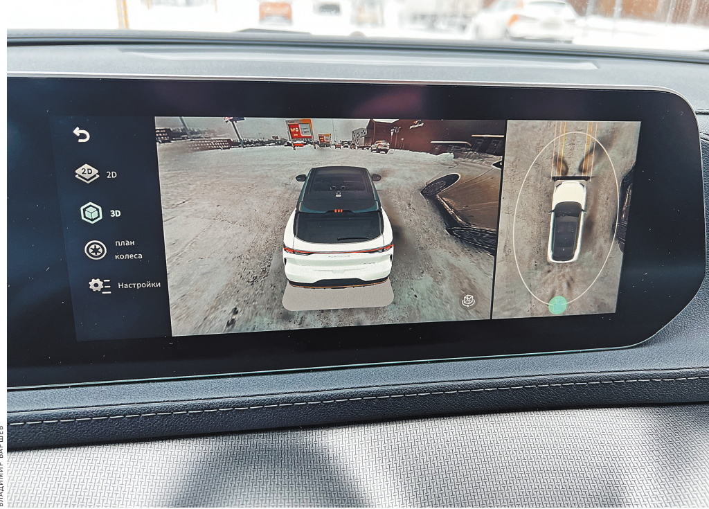
Evolut показывает обзор на 360 градусов. То есть при движении задним ходом сложно в кого-то везать.
